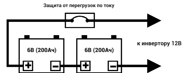
Блок аккумуляторов на 12 В (общая емкость = 200 Ач)
