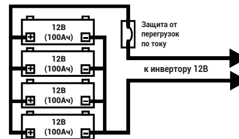
Блок аккумуляторов на 12 В (общая емкость = 400 Ач)
